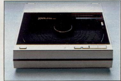
SL-10 Vollautomatischer Plattenspieler mit quartzeregelmtem Direktantrieb, servogeregelter Tangentialtonarm mit MC-Tonabnehmer EPC-310 MC. Eingebauter MC-Vorverstärker. Automatische Abtastung der Plattengröße durch Infrarot-Sensor. Gleichlaufschwankungen \pm 0,035\% . Horizontal- und Vertikalbetrieb möglich. Gehäusefarbe: silber.
