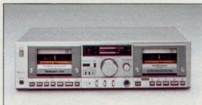
RS-M 202 Stereo-Cassetten-Deck mit 2 Cassettenteilen zum Duplizieren: Tape 1 Wiedergabe. Tape 2 Wiedergabe/Aufnahme, Dubbing-Funktion. Leichthubtasten. SX-Aufnahme/Wiedergabe-Köpfe. Auto-Tape-Select. Übertragungsbereich 30 Hz-17 kHz bei Reineisenband. 2farbiges Aussteuerungsanzeige mit „peak-hold“. Gehäusefarbe: silber.
