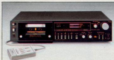
RS-M 270 X Stereo-Cassetten-Deck mit dbx-Rauschunterdrückungs-System, Dolby, MIC/LINE-Eingangswahlschalter, IC-Logic-Schaltung, 2 direktangetriebene Motoren, SX-Tonkopf. Übertragungsbereich 25 Hz-18 kHz bei Reineisenband. 2farbiges FL-Aussteuerungsanzeige mit „peak-hold“. Anschlußmöglichkeit für Zeitschaltuhr. „dbx-disc“-Position – Möglichkeit der Decodierung von dbx-codierten Schallplatten. Gehäusefarbe: schwarz.
