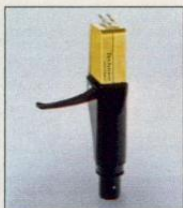
EPC-310 MC Dynamischer Tonabnehmer mit Boron-Nadelträger, elliptischer Diamant, incl. Systemträger, Übertragungsbereich 10-60.000 Hz.
