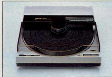
SL-7 Vollautomatischer Plattenspieler mit quartzeregelmtem Direktantrieb, servogeregelter Tangentialtonarm. Gleichlaufschwankungen \pm 0,035\% . Horizontal- und Vertikalbetrieb möglich. Incl. Magnettonabnehmer EPC-202. Gehäusefarbe: schwarz + silber.
